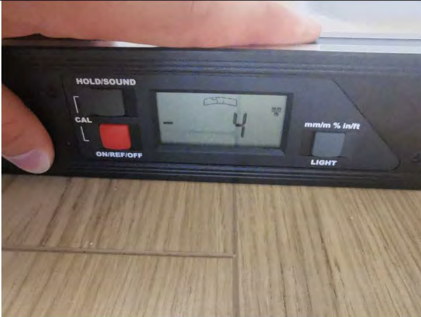
Фото №19. Измерение уровня пола в спальне.
