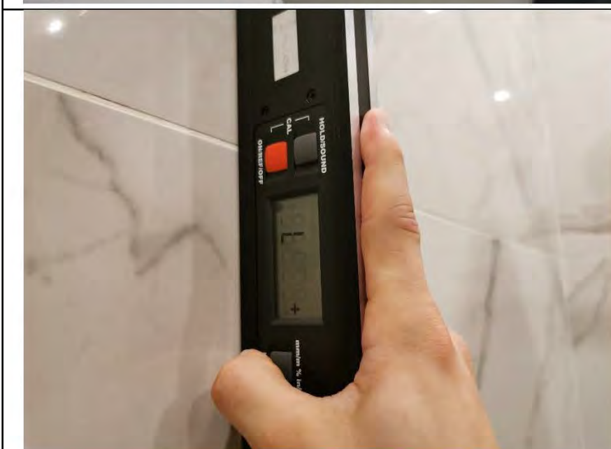
Фото №12. Измерение уровня стен в санузле.
